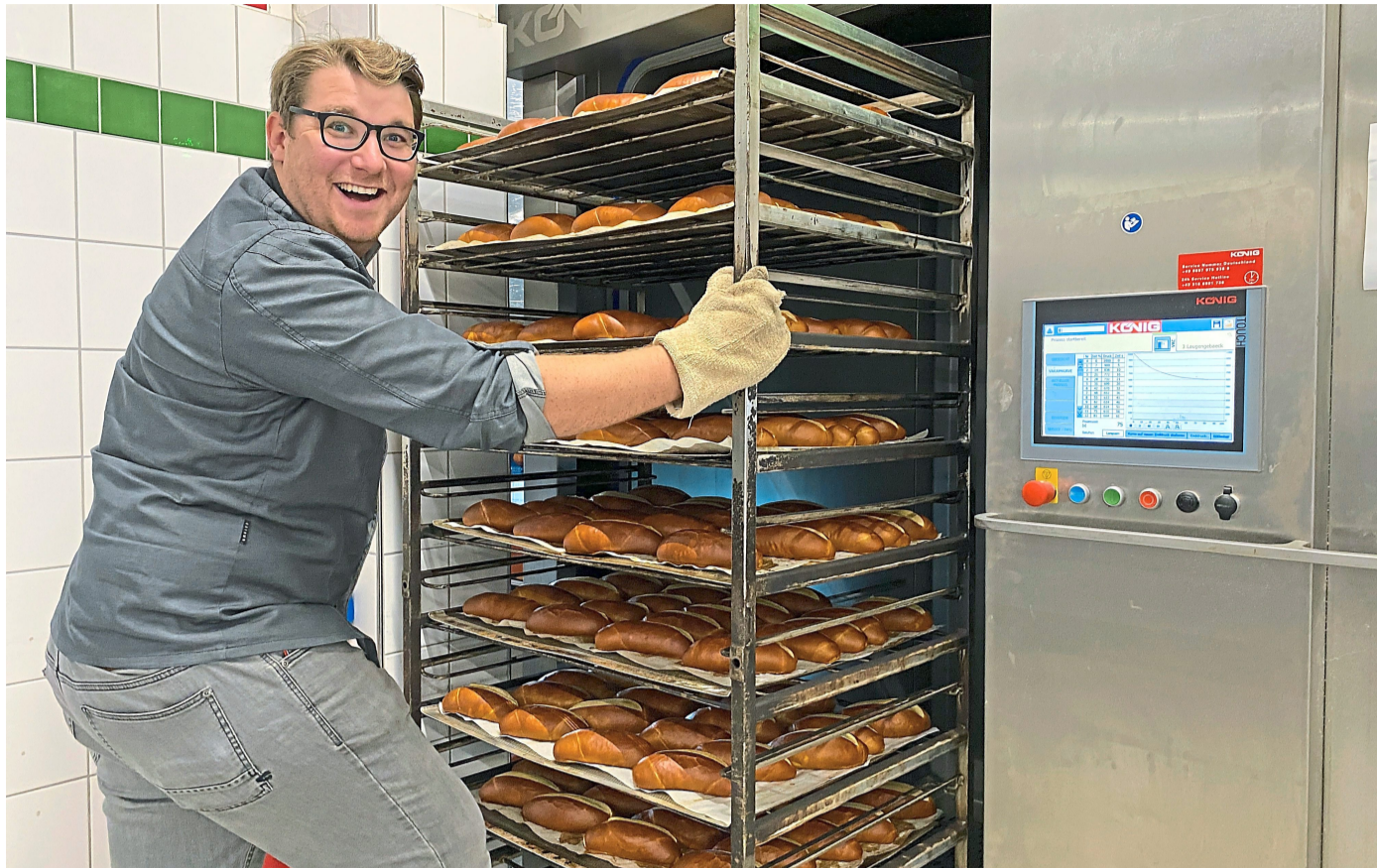
Bäckermeister Marc Mundri mit einer Ladung Laugenstangen an der neuen Vakuumkühlung der Bäckerei Diepenbrock. Statt die Backwaren bis zum Ende im Backofen zu belassen, wird das Produkt mit der Restwärme ausgebacken. Fotos: Klaus Meyer
